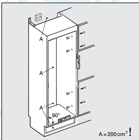
Перед встраиванием прибора следует выполнить тщательное выравнивание мебельного шкафа с помощью ватерпаса. Все углы шкафа должны составлять 90°, так как иначе дверца не будет прилегать со всех 4-х углов.
